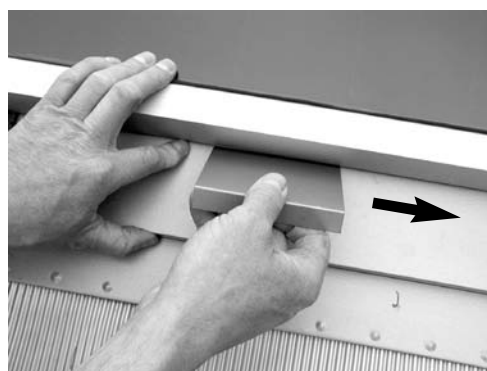
Colocar la fijación de la chapa de plomo y deslizarla hacia la derecha
