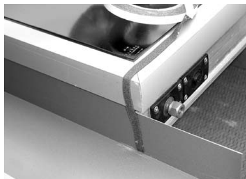
Pegue la banda de estanqueidad, empiece por la chapa lateral
