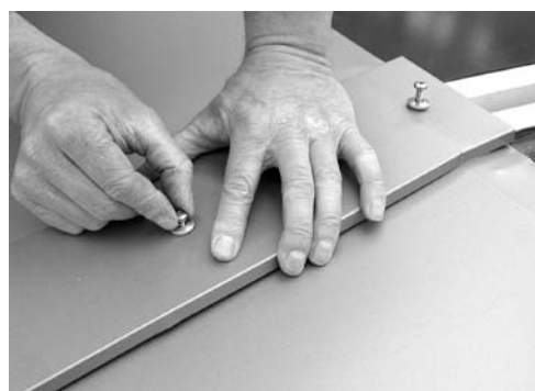
Coloque la pieza superior, inserte los tornillos con la mano
