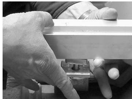
Inserte el tornillo de cabeza de martillo en el riel de sujeción
